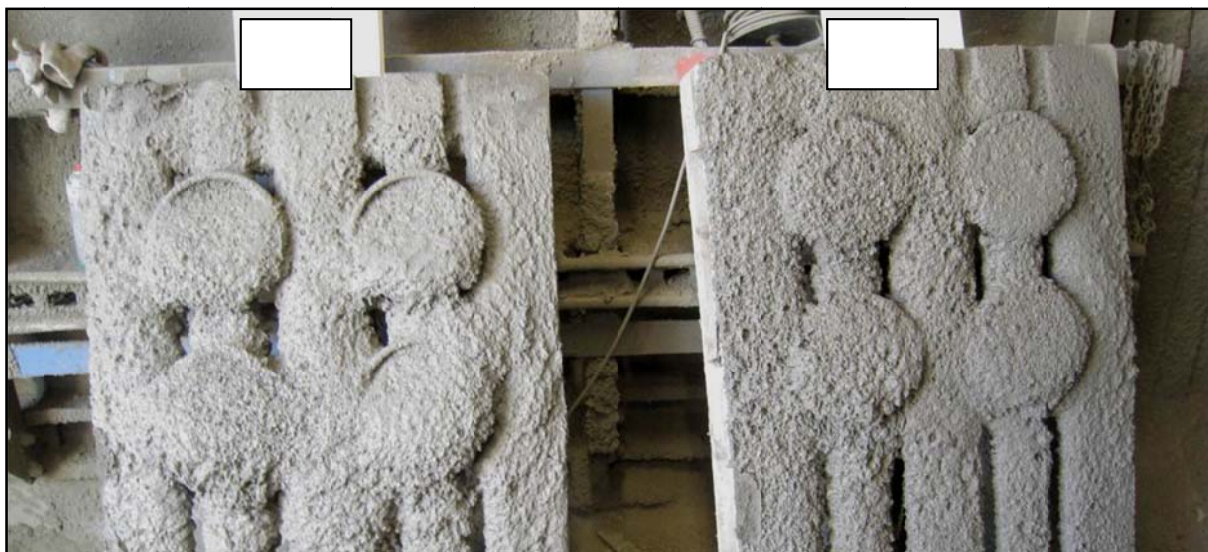
BILD 1. Den sprutade betongen. Konsistensen var något för lös i T50 blandningen vilket gjorde att provytorna blev lite hängande.
